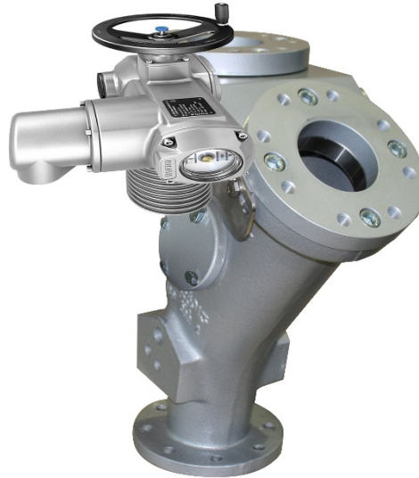
Zweiwegerohrweiche mit Elektromotorantrieb und Not Handantrieb
